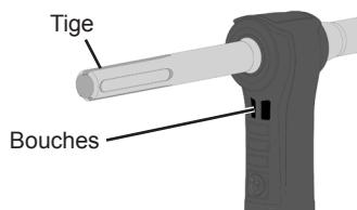
3. Attachez le trépan à la perceuse selon les instructions du fabricant de la perceuse.
